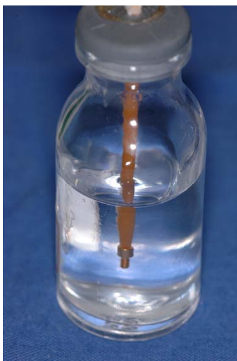
Figura 2: Aparato montado para teste in vitro. Cada amostra foi imersa em 10ml de saliva artificial e em recipientes de vidro individuais. Note o parafuso suspenso pela haste de madeira e em contato com a solução.
