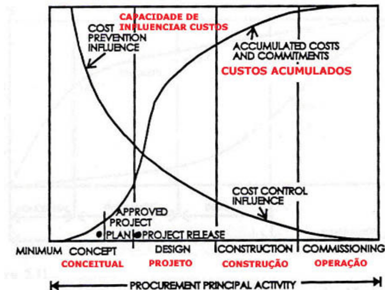
FIGURA 2. 10 – Influência de controle de custos durante as fases de projeto. Fonte: CE-693 Classroom Notes of CE-693 Administration of Construction Projects, citado por OLIVEIRA, 2004.
