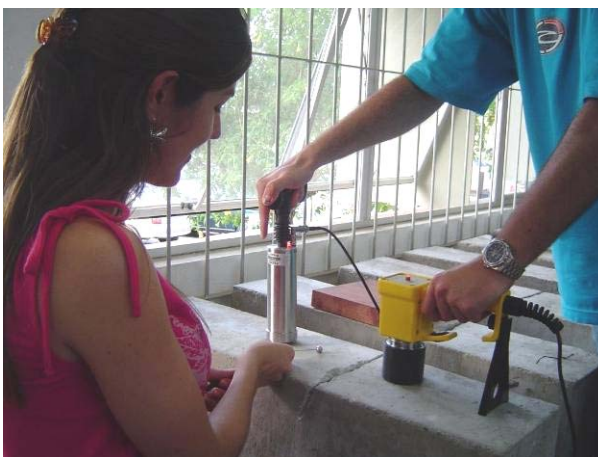
Figura 5.49 – Realização da leitura com Eco-Impacto – Obtenção da profundidade da fenda – Amostra 1.
