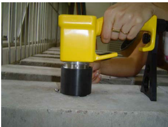
Figura 5.46 – Realização da leitura com Eco-Impacto – Obtenção velocidade ASTM C 1383.
