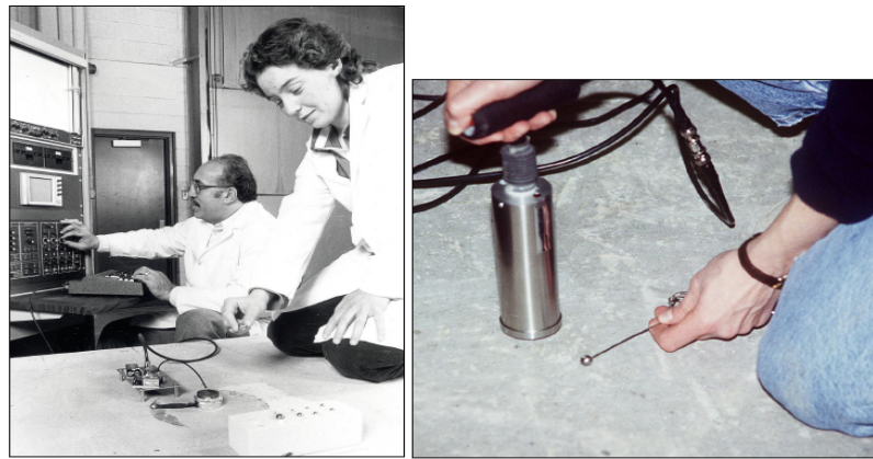
Figura 2.18 - (Esquerda) Esferas de aço para obter impactos com diferente tempos de contato; (Direito) Esferas de aço acopladas a hastes (Fonte: Carino, 2001).
