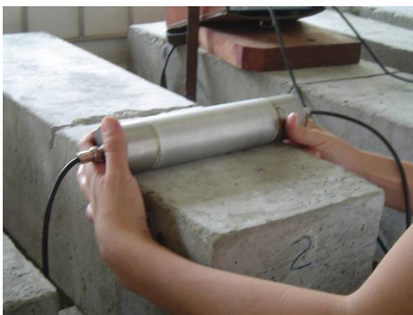
Figura 4.9 – Calibração do aparelho PUNDIT utilizado nos ensaios.
