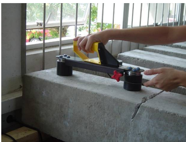
Figura 5.44 – Realização da leitura com Eco-Impacto – Obtenção velocidade.
