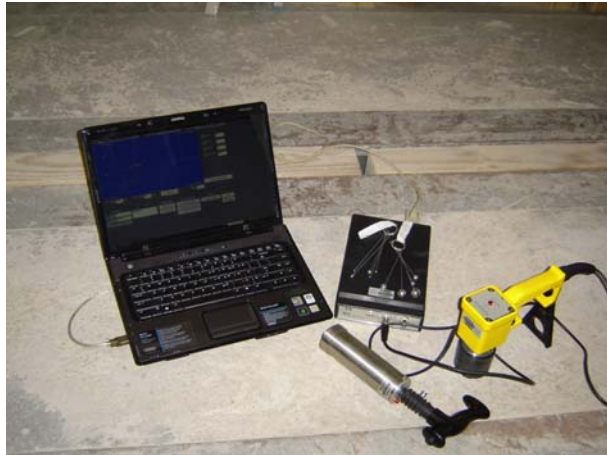
Figura 4.18 - Aparelho IMPACT-ECHO utilizado nos ensaios.
