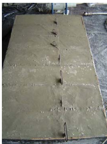
Figura 4.7 – Indução das fissuras com placas de aço.
