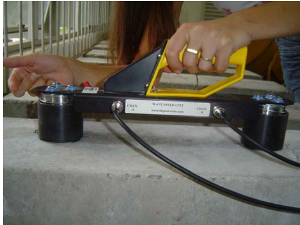
Figura 3.33 – Execução do ensaio para obtenção da velocidade da onda.
