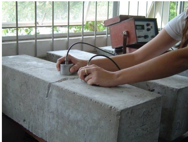
Figura 4.12 – Realização da leitura com o ultra-som – Procedimento A.
