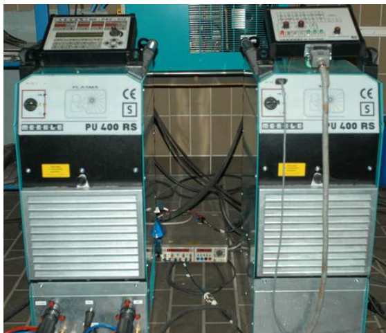
Figura 4.1 – Fontes de soldagem da bancada n. 1.
