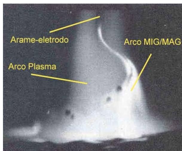
Figura 2.14 – Transferência rotacional no processo Plasma-MIG (Essers, 1972-2)
