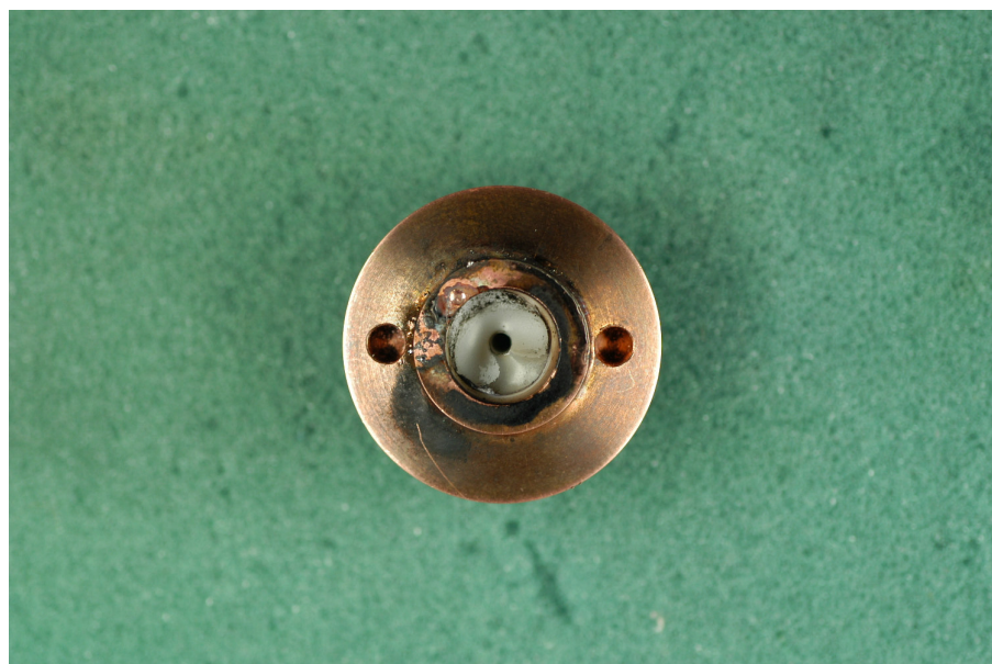
Figura 6.9 – Bucha de Nylon danificada pela ação do arco plasma
