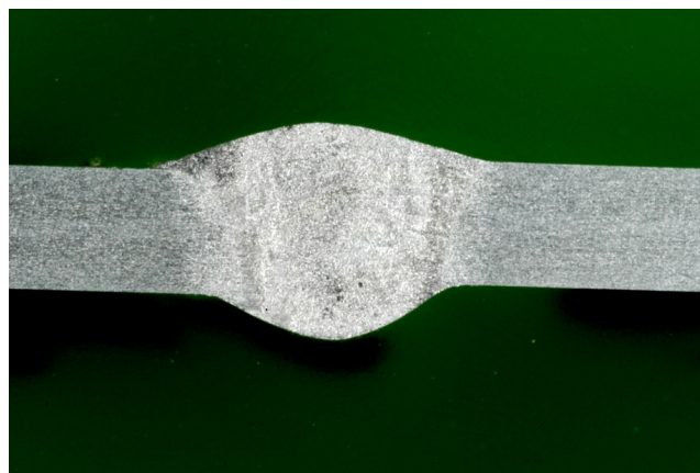
Figura 7.2 – Soldagem de chapas de alumínio. Espessura: 2 mm. Arame: AISi5, 1,2 mm de diâmetro. Velocidade de soldagem: 2,7 m/min. Demais parâmetros: Tabela 7.1.
