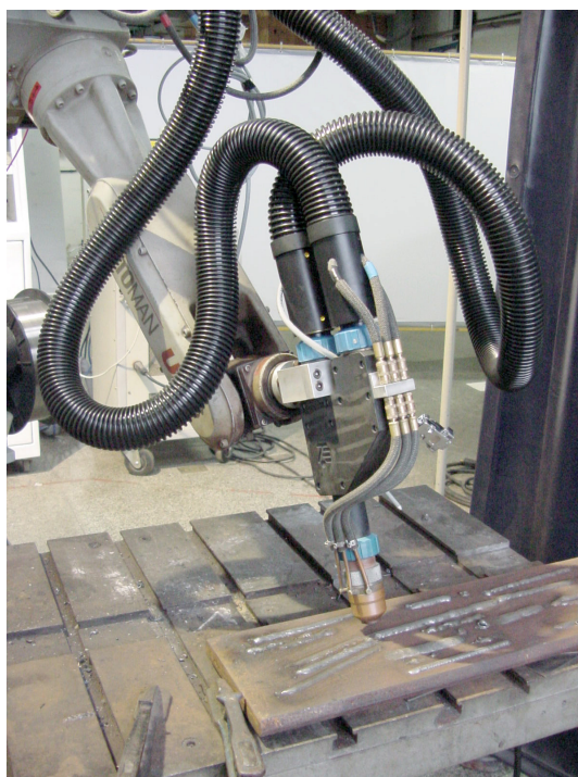
Figura 5.12 – Adaptação da extremidade do sexto eixo para suportar a pistola Plasma-MIG
