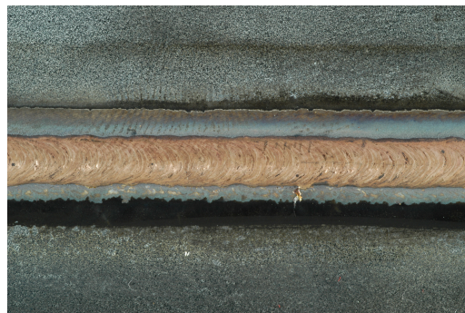
Figura 7.6 – Brasagem de chapa de aço galvanizado 1 mm de espessura, realizada pelo processo Plasma-MIG. Vs = 4 m/min. Demais parâmetros: Tabela 7.5.
