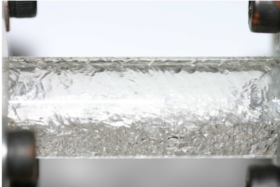
Figura 5.31: Visualização do escoamento em padrão anular para tubo liso a G = 250\text{kg/m}^2\text{s} , x = 0,18 e q'' = 4,7\text{kW/m}^2 .
