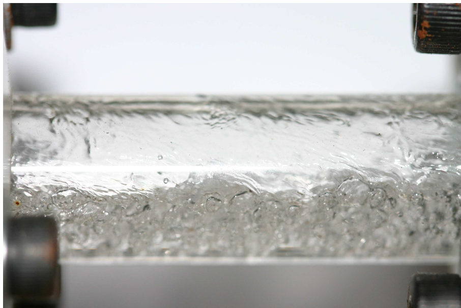
Figura 5.35: Visualização do escoamento em padrão anular com bolhas para tubos micro aletados a G = 200\text{kg/m}^2\text{s} , x = 0,21 e q'' = 14,2\text{kW/m}^2
