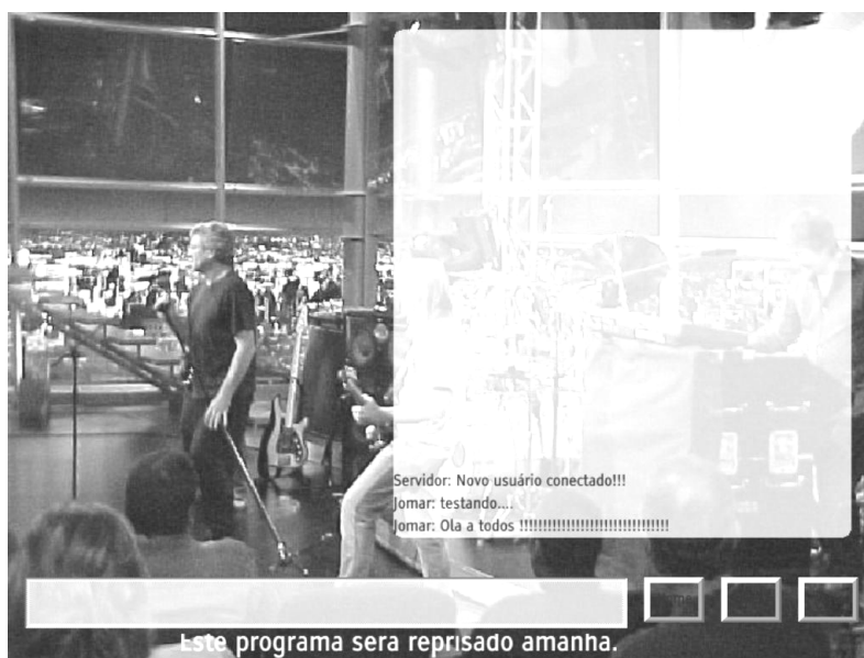
Figura 26. Emulador IRT com aplicação de chat e teletexto em execução.
