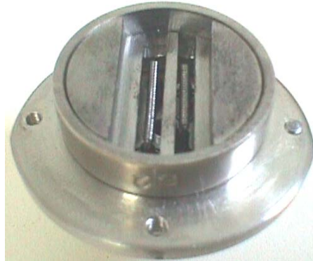
Figura 2.10 Copo catódico - vista frontal do filamento maior (à esquerda) e filamento menor (à direita).
