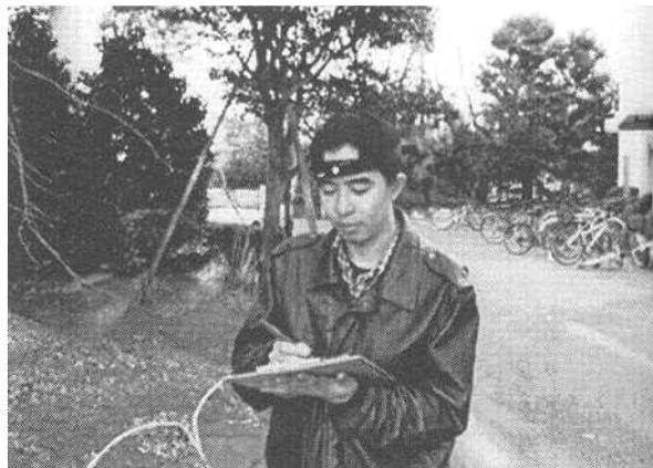
Figura 2-24. Sujeito com um fotômetro (luxímetro) acoplado na região frontal da cabeça. Fonte: Shukuya e Morihana (2000).
