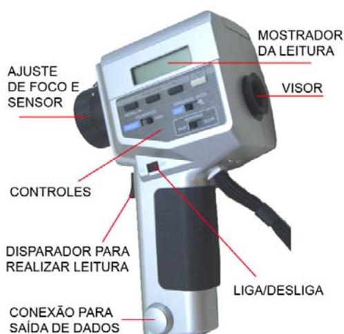
Figura 2-03. Exemplo de luminancímetro para medição de luminâncias.
