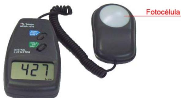
Figura 2-02. Exemplo de luxímetro para medição de iluminância.
