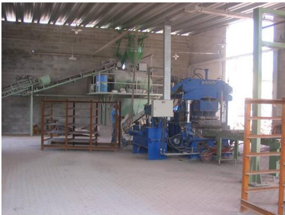
Figura 2.1 – Exemplo de vibro-prensa fixa utilizada na produção de blocos de concreto.
