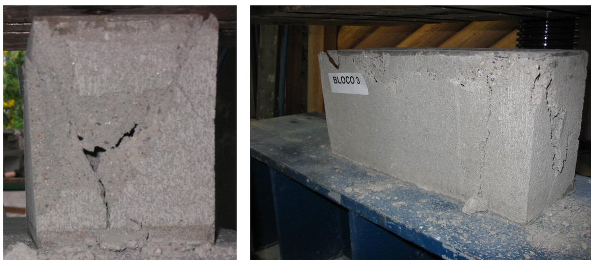
Figura 6.1 – Ruptura típica dos blocos sob compressão.
