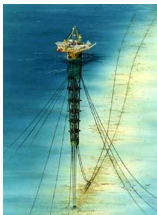
Figura 1 – SCR conectando a plataforma de produção às cabeças de poço.
