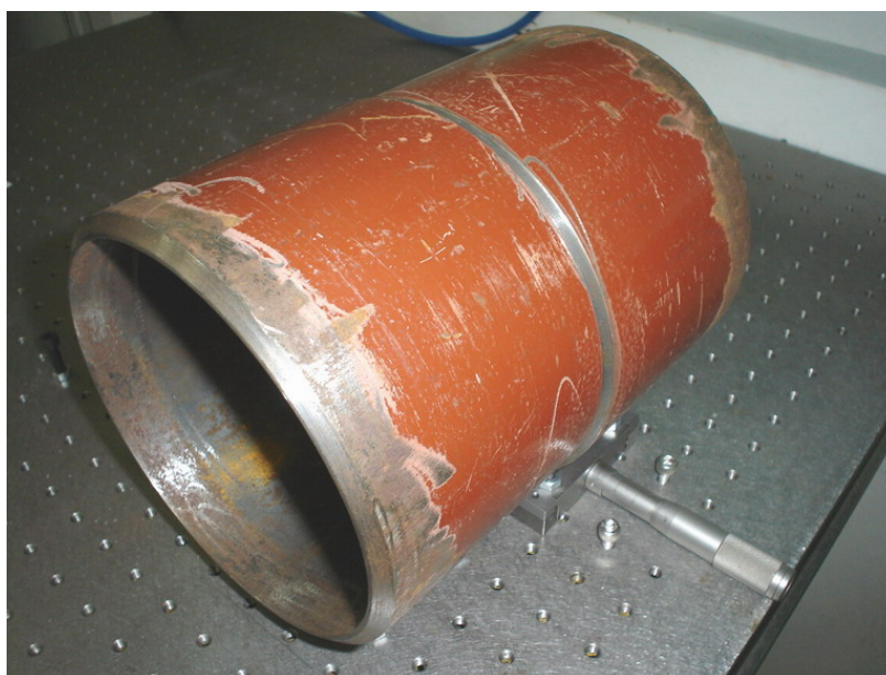
Figura 55 – Bancada de desalinhamentos transversais.
