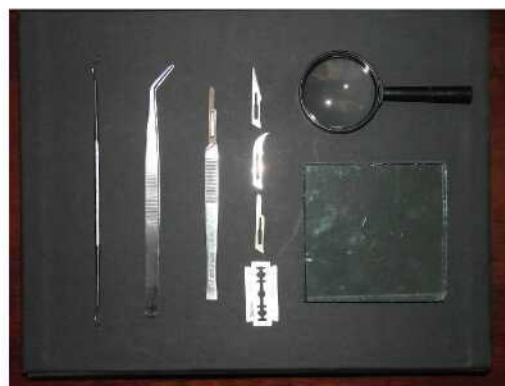
Ilustração 35 - Materiais utilizados na coleta de amostra e no preparo das lâminas de madeira. Foto da autora.
