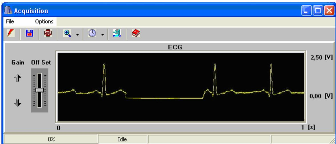
Figura 3.2: Tela do Fisiógrafo exibindo a perda de pacotes – leva o sinal para zero.
