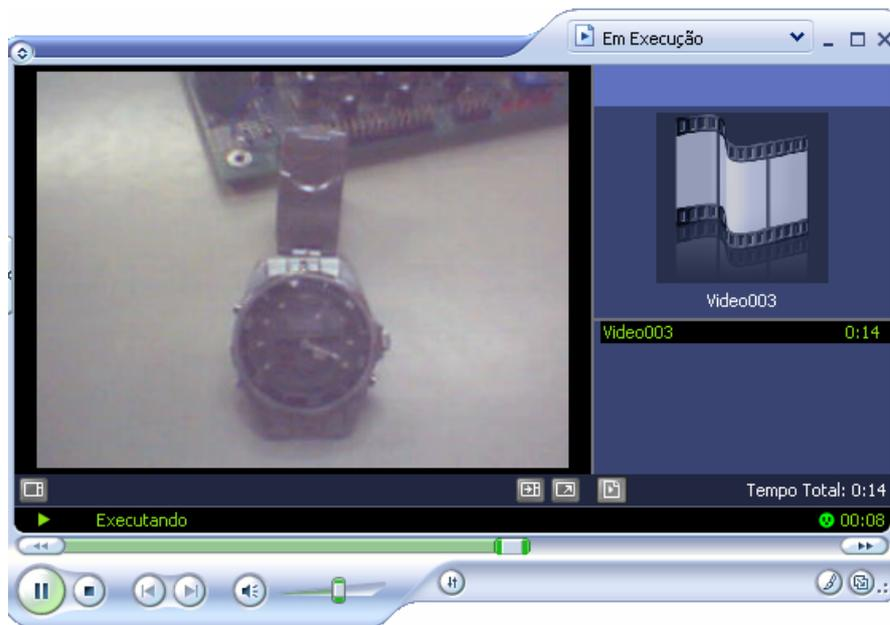
Figura 4.1: Teste de aquisição do sinal de vídeo: Compara o tempo gravado pela câmera com o tempo registrado pelo relógio analógico.
