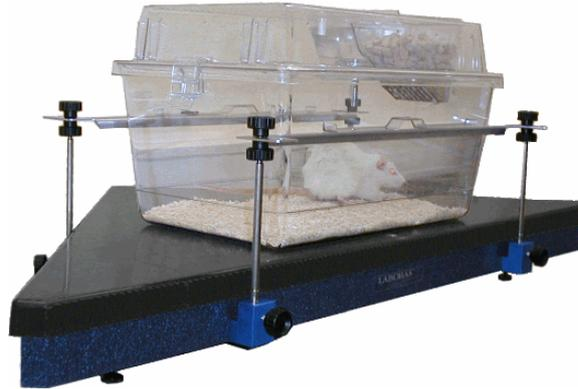
Figura 2.1: Laboras– Equipamento feito com sensores de pressão que captam diversas vibrações que caracterizam diferentes categorias comportamentais pré-determinadas, adaptado de <<http://www.metris.nl/laboras>>.
