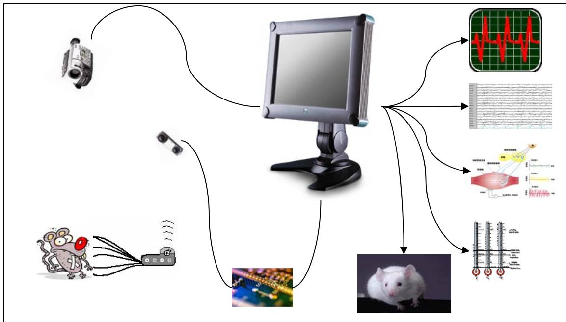
Figura 2 - Visão Geral do Sistema EtoFisiógrafo. Os dados eletrofisiológicos são coletados do animal e transmitidos a uma unidade receptora que, por sua vez, os retransmite a um computador.
