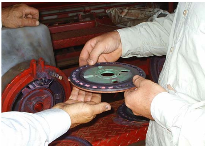
Figura 20: Seleção do disco da plantadeira de acordo com as sementes de milho.
