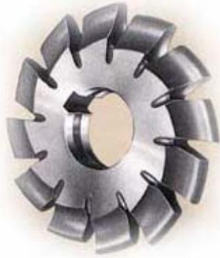
Figura 2.12 - Fresa módulo para a usinagem de engrenagens.
