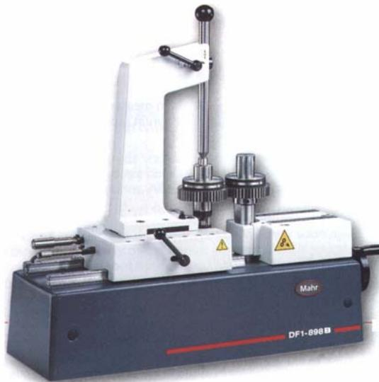
Figura 3.26 - Engrenômetro para medição dos desvios de conjunto.
