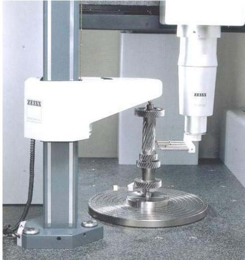
Figura 3.16 - CMM equipada com uma mesa rotativa (Zeiss ZMC 550).
