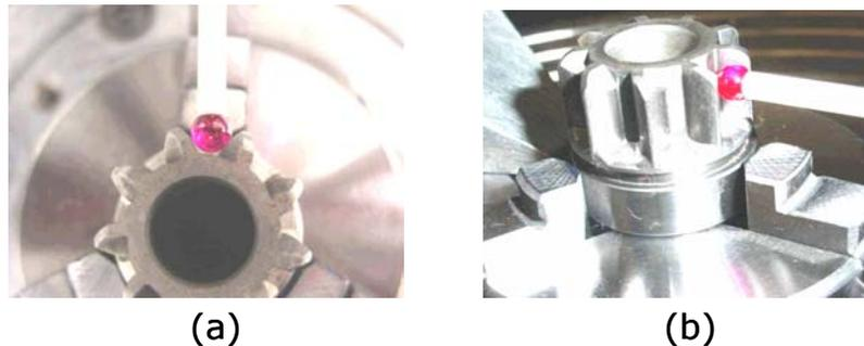
Figura 3.17 - Vista superior (a) e frontal (b) da medição do batimento.
