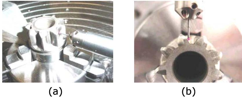
Figura 3. 18 - Vista frontal (a) e superior (b) da medição do perfil.
