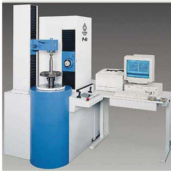
Figura 3.25 - Máquina dedicada para medição de engrenagens.
