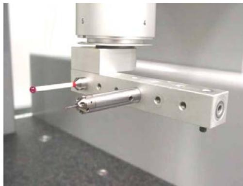
Figura 3.19 - Apalpadores para a medição de engrenagens de dentes externos.
