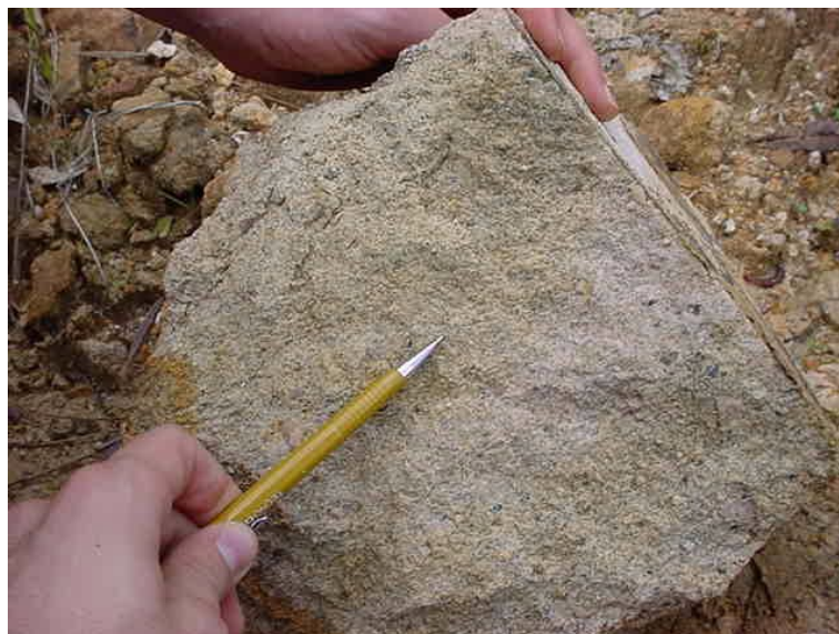
Figura 44 – Textura do material encontrado na área de escorregamento
