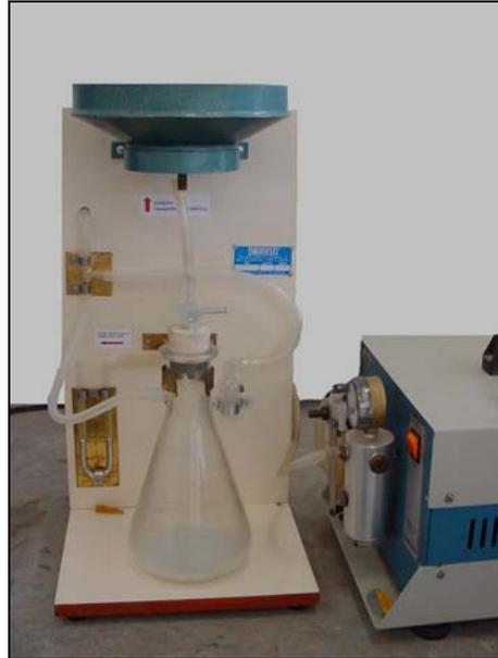
**Figura 3.5 – Equipamento utilizado para determinação da retenção de água**
