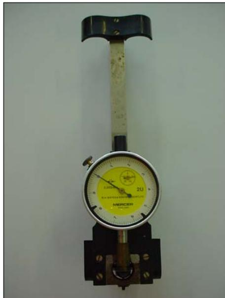
**Figura 3.10 – Equipamento utilizado para determinação da variação dimensional dos corpos-de-prova (*demec-gauge*)**
