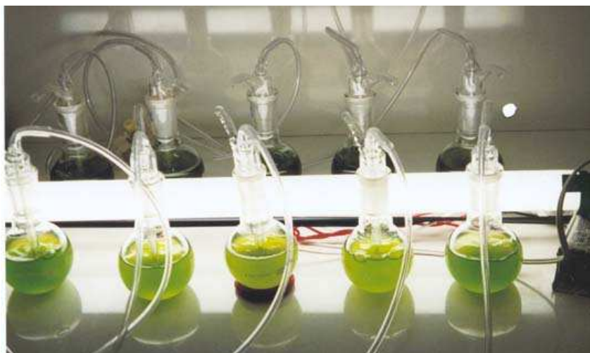
Figura 4: Biorreatores para crescimento das algas.
