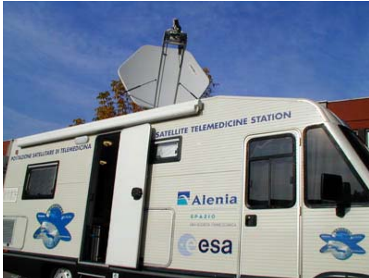
Figura 7 - Estação móvel de telemedicina por satélite.
