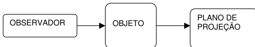
Figura 11: Seqüência de representação da projeção ortogonal no 1º Diedro.
