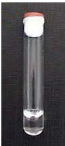
Figura 5.1 – Ampola utilizada para conduzir as reações de polimerização em massa
