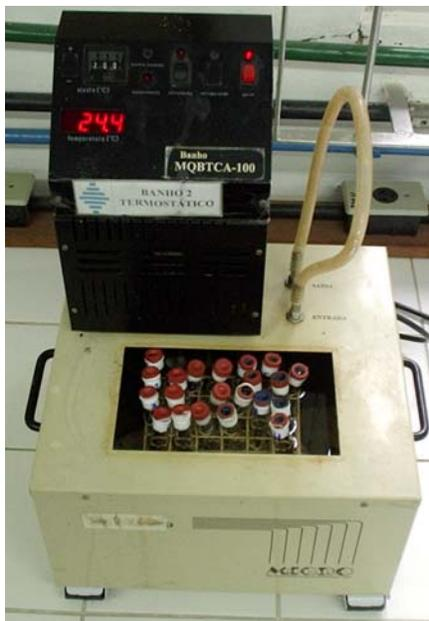
Figura 5.2 – Esquema experimental utilizado nas polimerizações em massa
