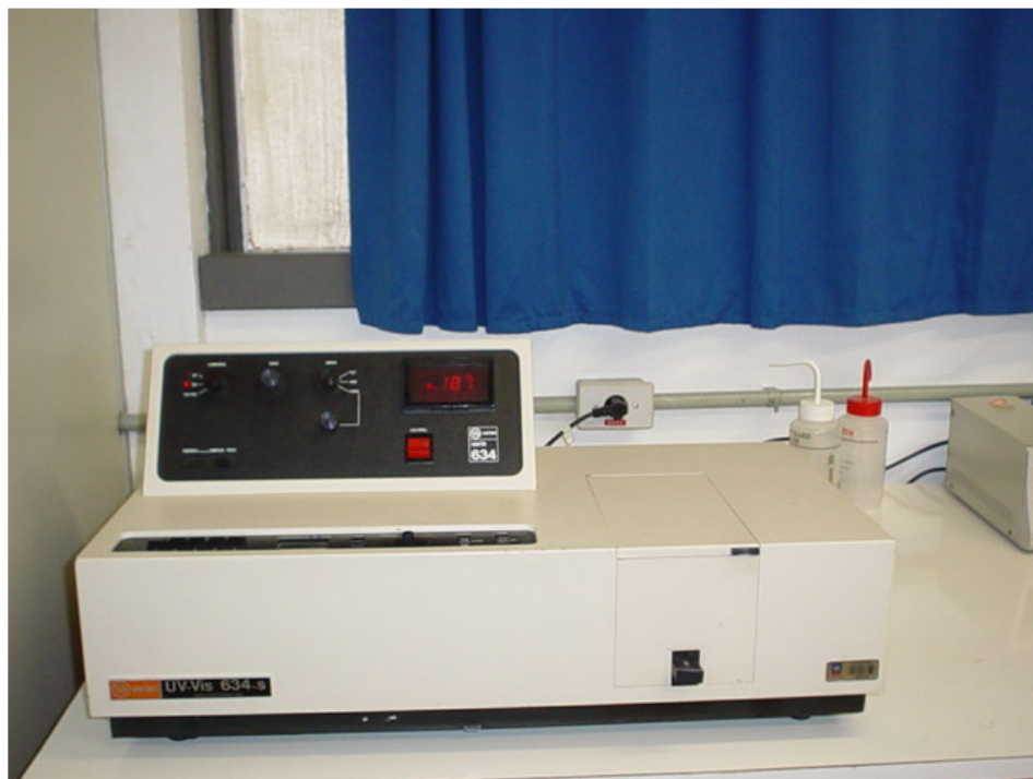
FIGURA 6 – Espectrofotômetro utilizado para leitura da absorvância das amostras – método colorimétrico.
