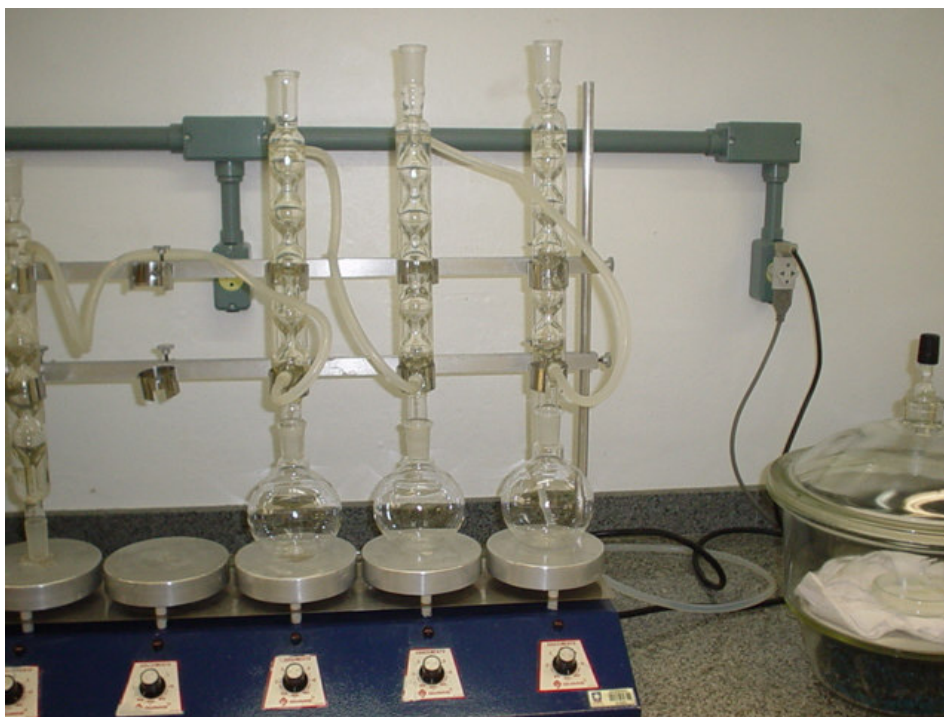
FIGURA 4 – Aparelho de digestão utilizado para determinação da DQO pelo método titulométrico de refluxo aberto
