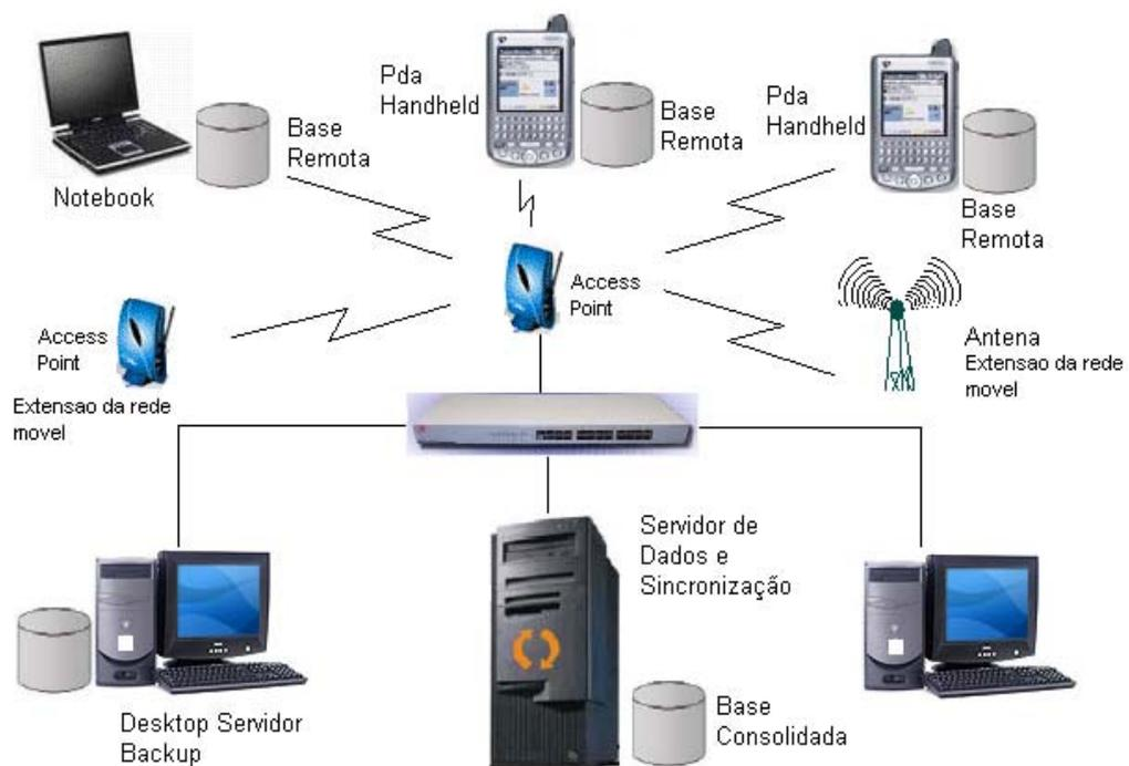
**FIGURA 19 - Modelo Cliente/Servidor – Comunicação Rede Fixa com Clientes Móveis.**
