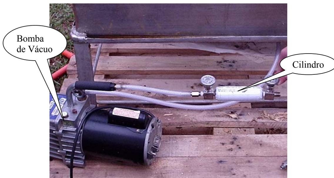
Figura 17: Foto do Sistema de Coleta de Gases de Exaustão.
