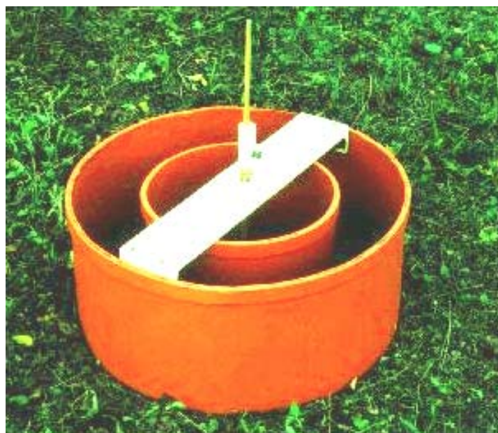
Figura 05: Infiltrômetro com medidor de nível d'água por flutuador (bóia), elaborado através do laboratório de hidráulica do Departamento de Engenharia Sanitária e Ambiental da UFSC. (Foto: Prof Péricles Alves Medeiros.).
