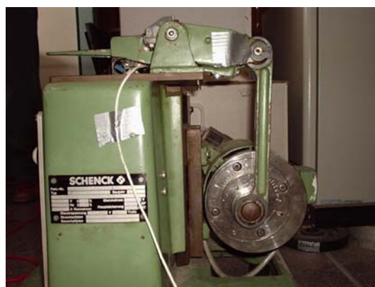
Figura 5.4: Vista superior da máquina de fadiga.
