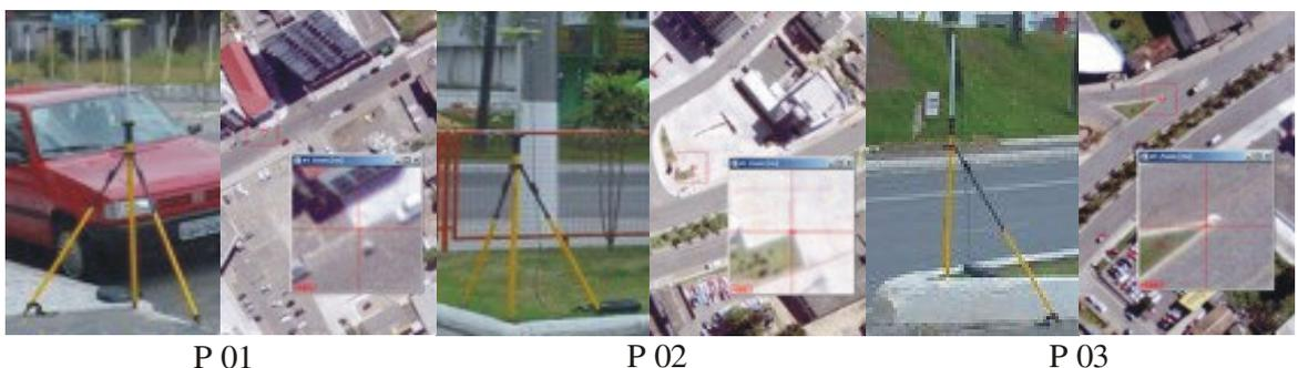
FIGURA 4.10- Definição dos pontos de controle (P01, P02 e P03) na imagem e no terreno.
