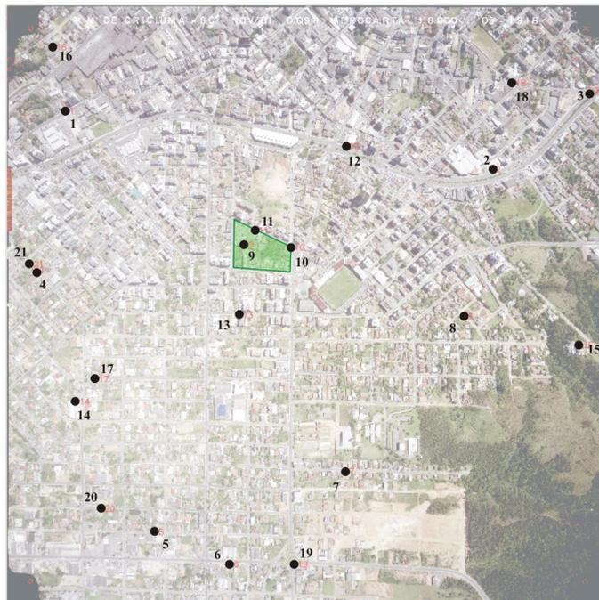
FIGURA 4.9- Distribuição dos 21 pontos de controle na fotografia aérea destacando a área de estudo.
