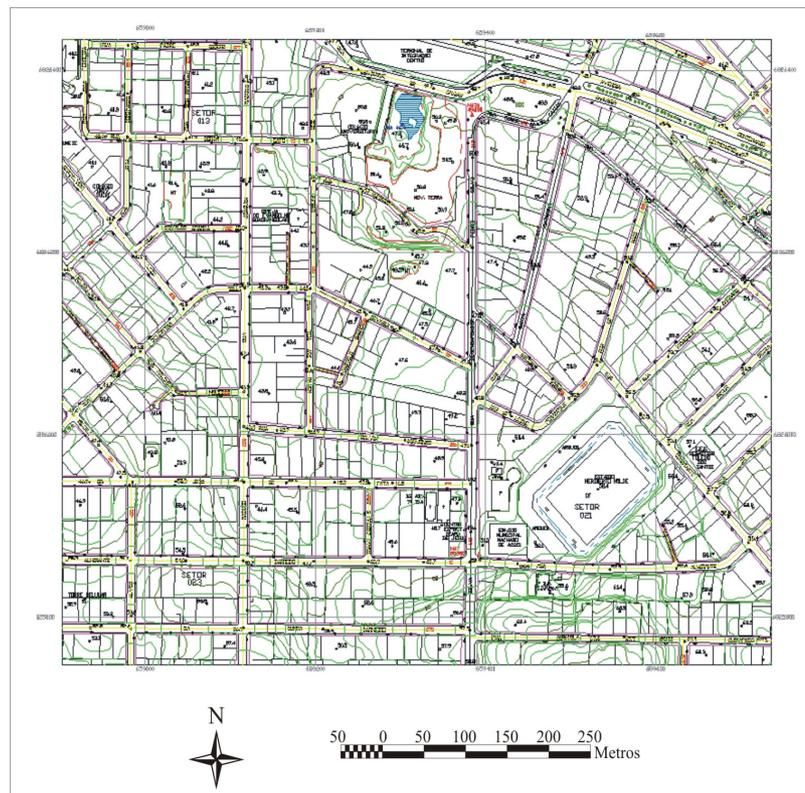
FIGURA 4.1- Restituição estereofotogramétrica de parte de uma carta da área urbana de Criciúma, SC.
