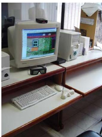
*FIGURA 11* – Equipamento para restituição fotogramétrica.
