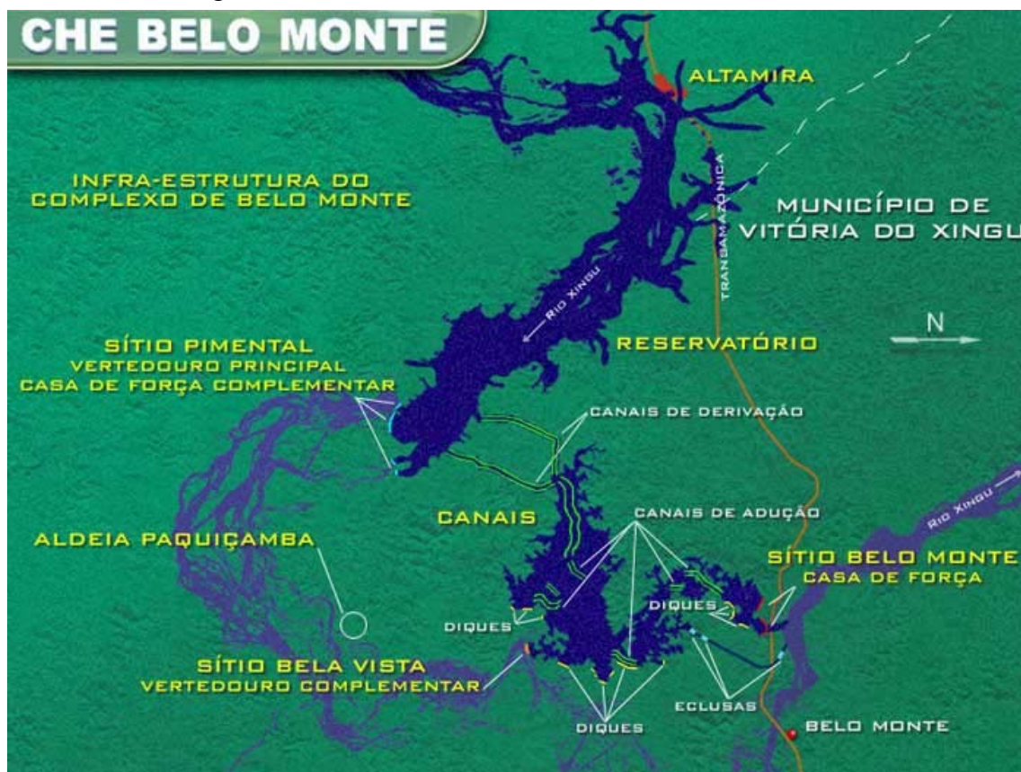
Figura 4.1 – Infra-estrutura do CHE Belo Monte
