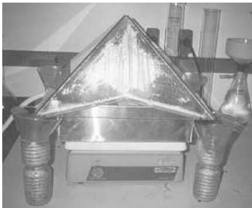
Figura 13 – Foto da cobertura de 45°, com aquecimento artificial (chapa de aquecimento)
