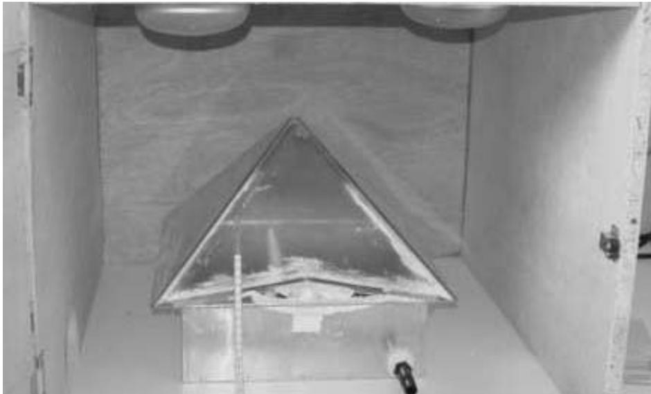
Figura 15 – Foto do equipamento de base de alumínio com gotículas de água
