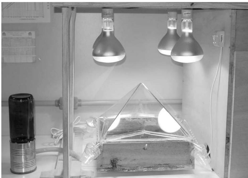
Figura 14 - Foto do equipamento com base de madeira para testar a melhor lâmina d'água
