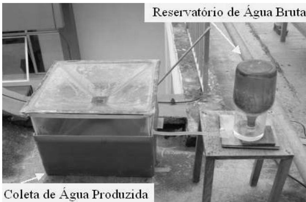
Figura 27 – Foto do equipamento de tratamento de água utilizando pirâmide invertida
