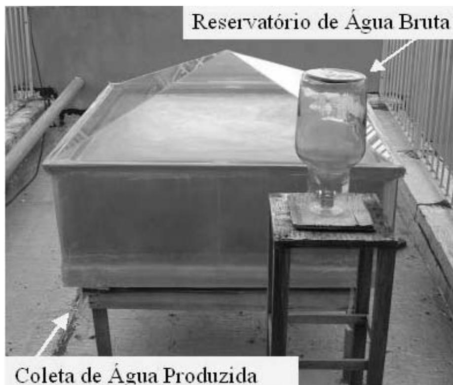
Figura 24 – Foto do equipamento otimizado com reservatório acoplado de água produzida
