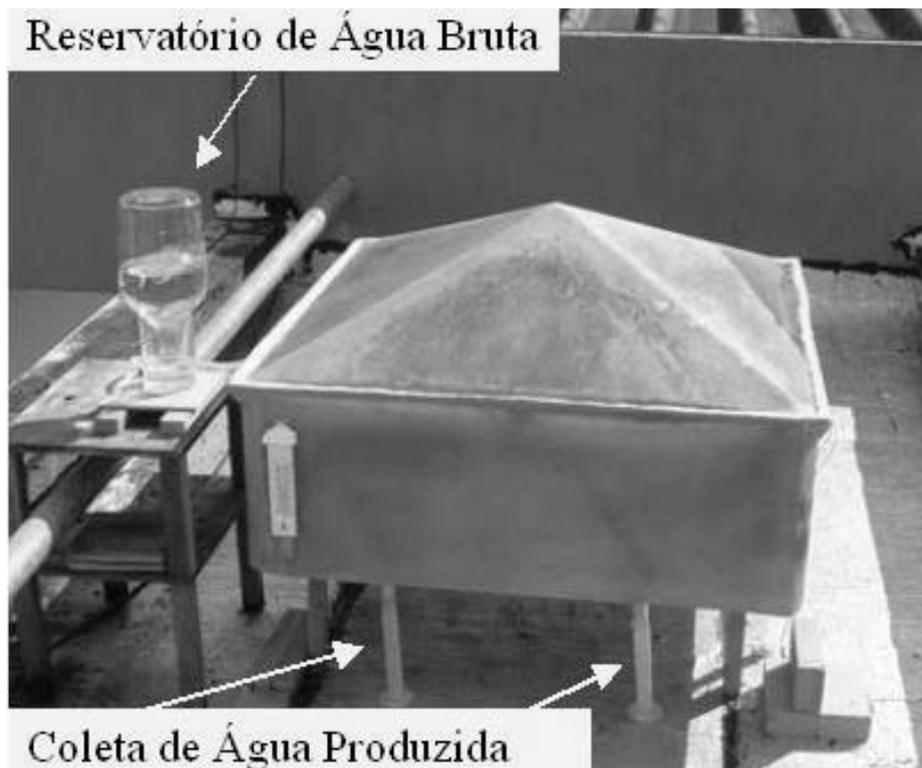
Figura 23 – Foto do equipamento de tratamento de água otimizado
