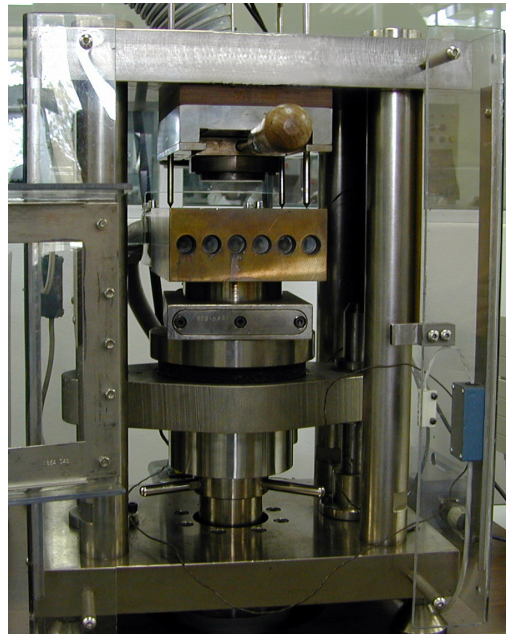
Figura 2.23 : Máquina de compressibilidade.
