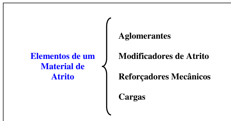
Figura 2.16 : Elementos de um material de atrito.
