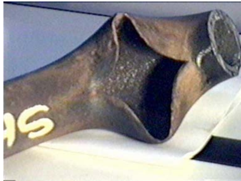
Figura 5 – Rompimento de tubo por sobreaquecimento de curta duração.
