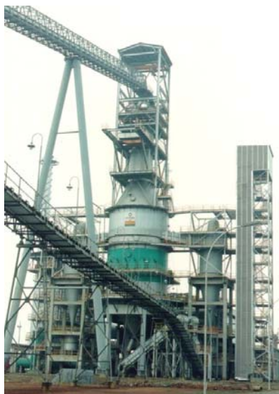
FOTO 6: Retorta Petrosix “Coração do Processo de Petrosix”. FONTE: Acervo da Petrobrás-SIX – 2000.
