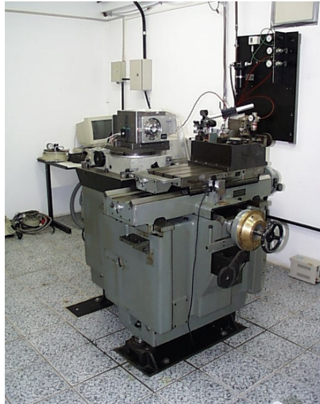
Figura 5.27 – Configuração final do torno de ultraprecisão.
