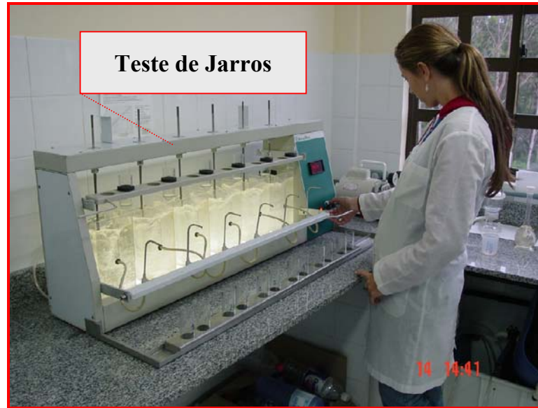
Figura 2.2 – Foto dos ensaios realizados em jar test
