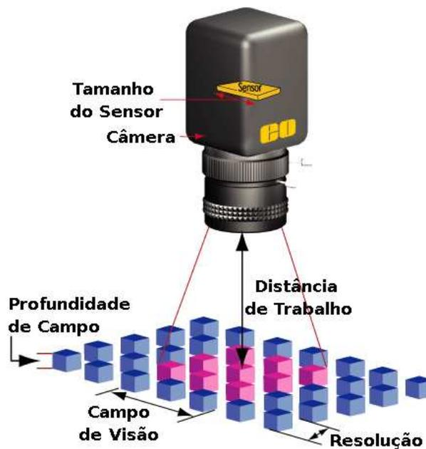
**Figura 3.5:** Parâmetros para a especificação de um sistema de visão.
