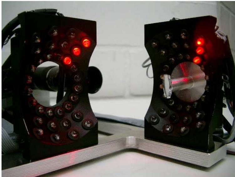
**Figura 4.5:** Protótipo do segundo subsistema de iluminação desenvolvido para o sistema TOOLSPY.
