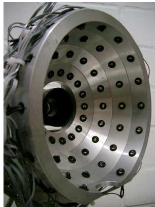
**Figura 4.4:** *Protótipo do primeiro subsistema de iluminação desenvolvido para o sistema TOOLSPY.*
