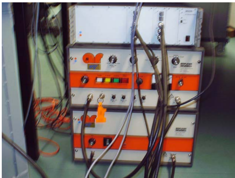
Foto 1 – Amplificadores de RF Amplifier Research (150 W / 10kHz – 100 MHz e 100 W / 80 MHz – 1 GHz).
