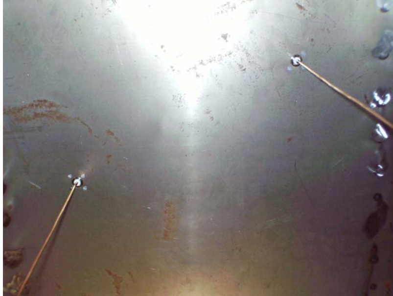
Foto 2 – Interior da câmara analisada: arranjo de linhas de transmissão.
