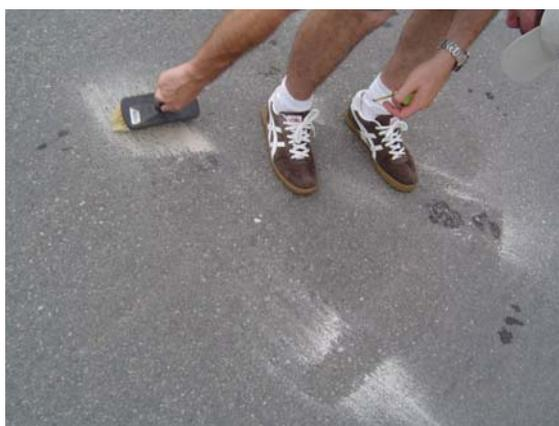
**Figura 3.2 – Limpeza da superfície antes realização do ensaio**
