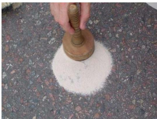
**Figura 3.4 – Espalhamento da amostra de areia usando o soquete**
