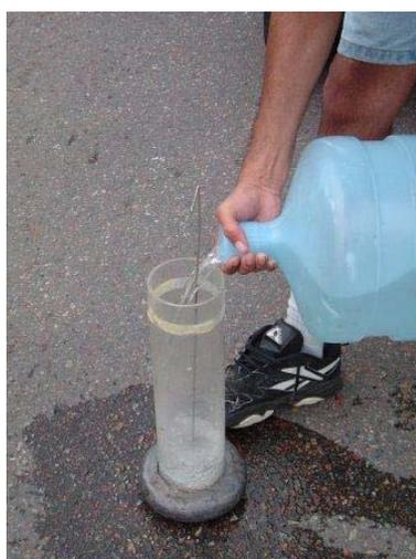
**Figura 3.8 – Enchimento do drenômetro com água até o segundo menisco**
