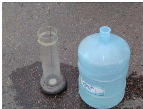
**Figura 3.6 – Drenômetro (LTP/EPUSP) e galão de água**
