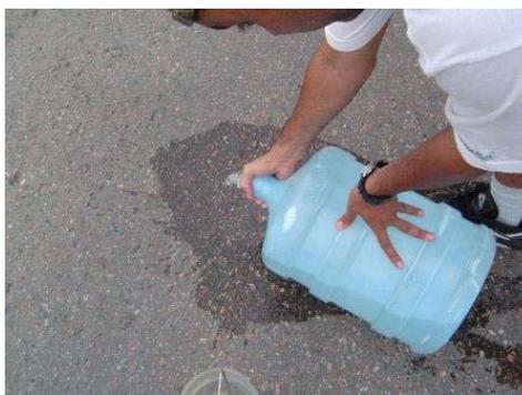
**Figura 3.7 – Local sendo molhado para realização do ensaio de drenabilidade**
