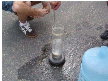
**Figura 3.9 – Um operador registrando o tempo de escoamento e o outro liberando a rolha do drenômetro fazendo escoar a água**
