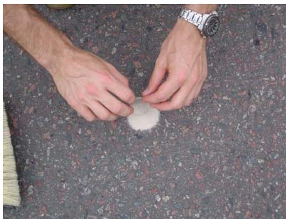
**Figura 3.3 – Espalhando a amostra de areia sobre a superfície do revestimento**
