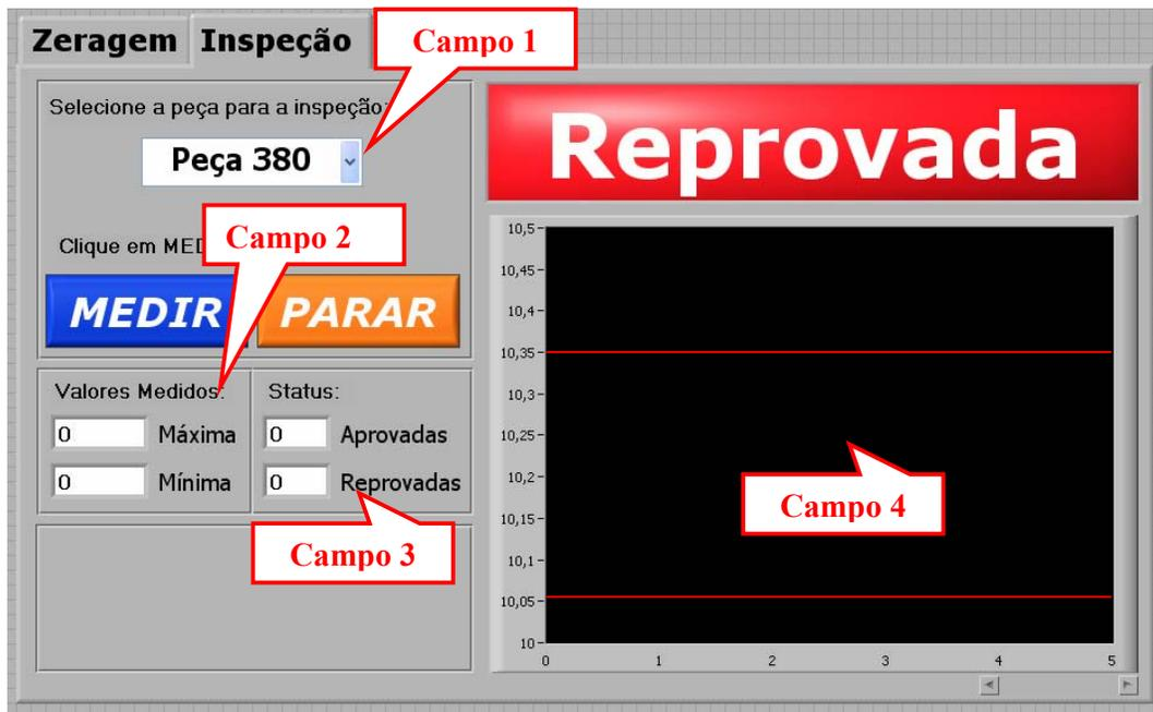
Figura 4.27: Tela de inspeção do software para automação e controle da medição [38].
