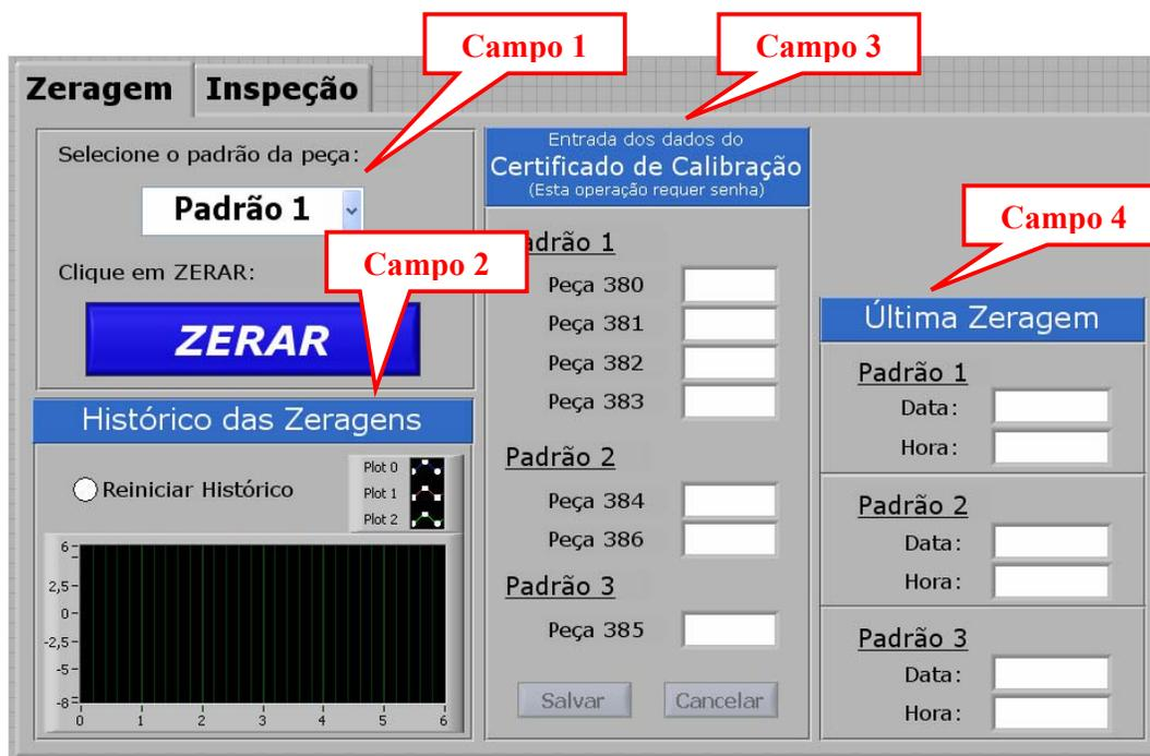
Figura 4.25: Tela de zeragem do software para automação e controle da medição [38].
