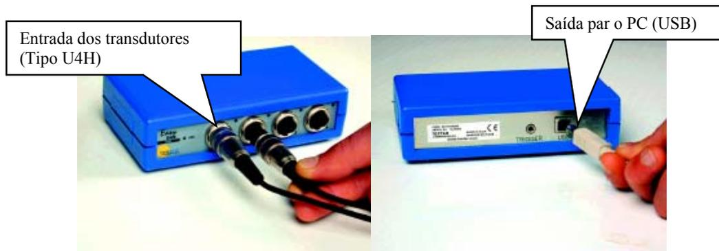
Figura 4.24: Easy Box™ - Interface para aquisição de dados.
