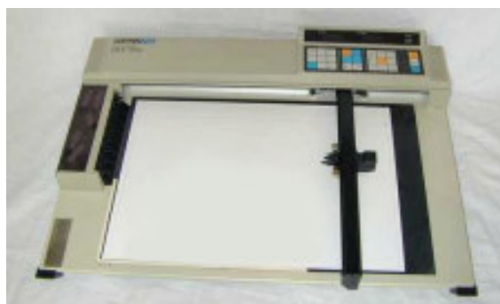
Fig. 13. Vista de um plotter utilizando a concepção pórtico X-Y.
