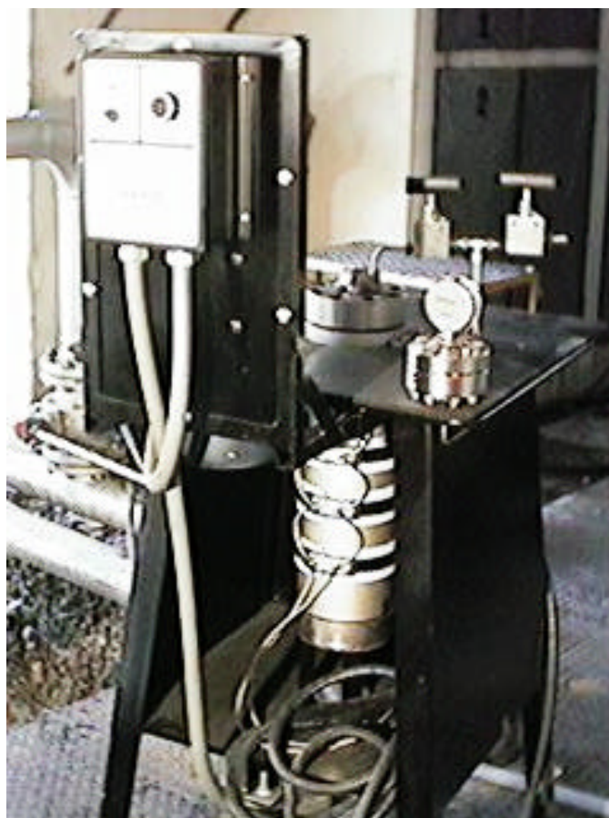
Figura II.14: Foto da autoclave para testes de corrosão em meio estático
