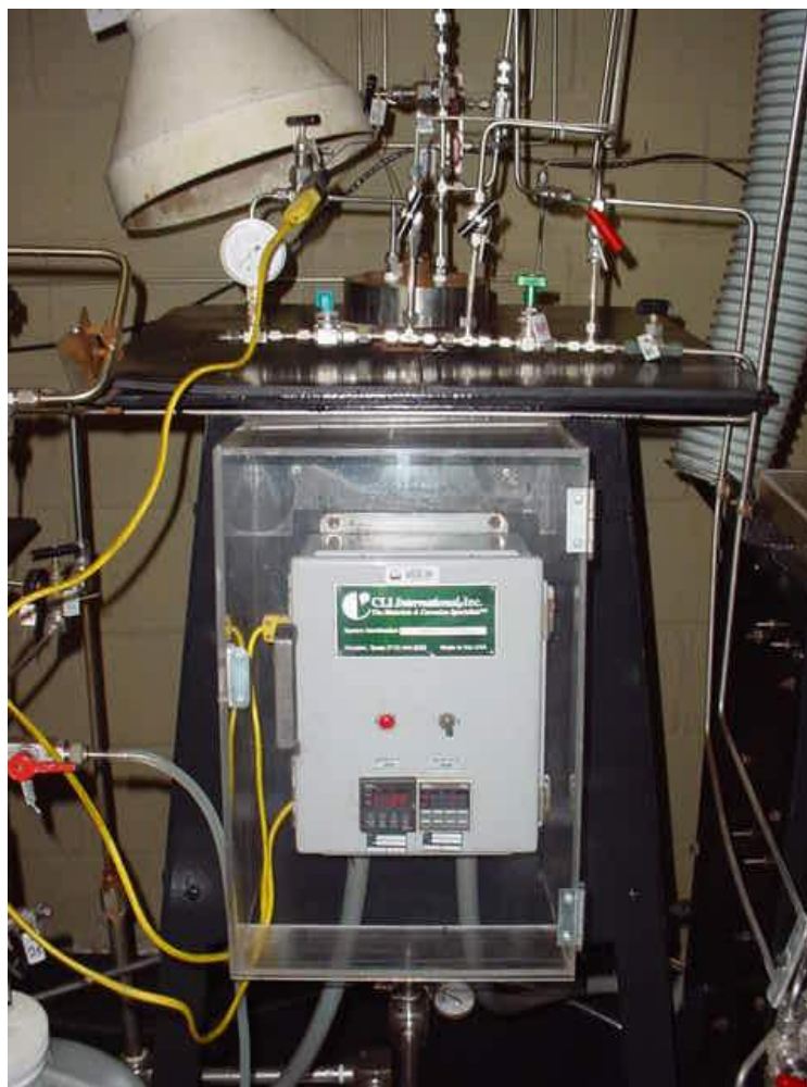
Figura II.11: Foto da autoclave I devidamente instalada em sua bancada, apresentando o conjunto de válvulas de entrada e saída de gases do LOOP, bem como os controladores eletrônicos da temperatura.
