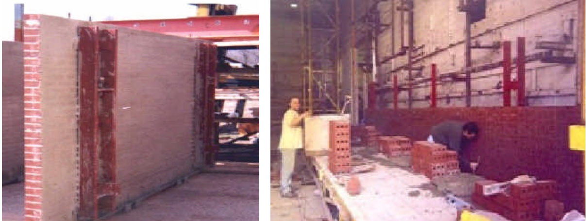
Ilustrações 2.8. e 2.9. Elemento de fixação e processo de fabricação (HOBBS; DAWOOD, 2000)
