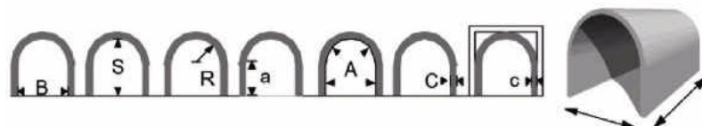
Ilustração 2.7. Dimensões variáveis do sistema construtivo (SARRABLO, 2001)
