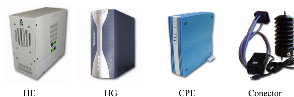
Figura 5.3: Conjunto PLC utilizados nos testes
