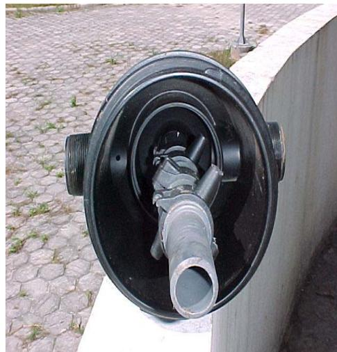
Figura 13. Foto do filtro piloto modelo 2'' T-S      Figura14. Foto interior do filtro 2'' T-S
