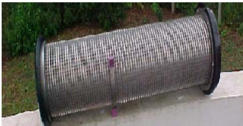
Figura 15. Foto da micropeneira de 50  $\mu\text{m}$  do piloto.
