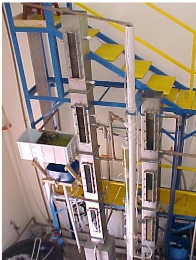
Figura 09. Foto da unidade piloto de filtração direta descendente.
