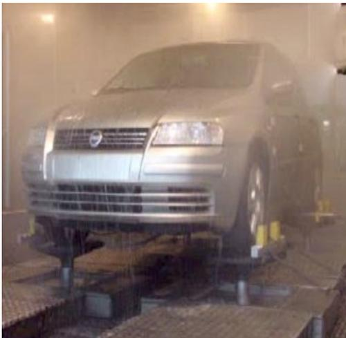
Além da redução de custo e maior possibilidade de repetibilidade, as provas em laboratório nos permitem um maior controle das condições de contorno, minimizando os riscos inerentes a um processo de experimentação em estradas.
