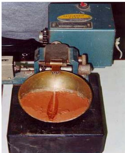
**Figura 9 - Aparelho de casagrande para determinação do limite de liquidez**
