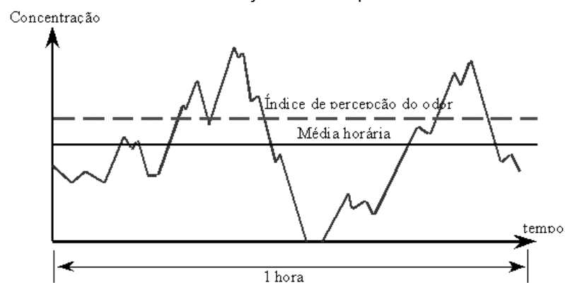
Figura 21 - O modelo gaussiano para emissões contínuas e as flutuações de concentração de curto período
