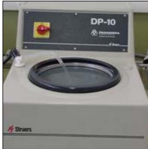
Figura 7 - Politriz (Modelo DP-10, Struers/ Panambra Industrial e Técnica Ltda., São Paulo, SP, Brasil) utilizada para acabamento dos cilindros de cimentação.
