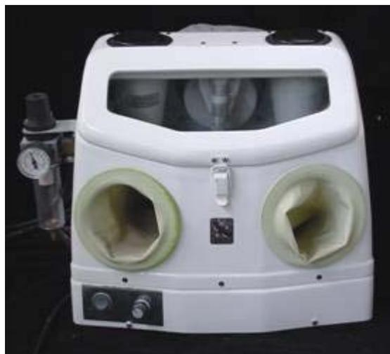
Figura 10 - Aparelho de jateamento (F&F Equip. Med. Odont., Araraquara, São Paulo) utilizado para limpeza dos cilindros metálicos para cimentação.
