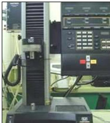
Figura 29 - Máquina de testes universal Instron (modelo 4444, Instron Inc., Canton, EUA) utilizada para o teste de tração.
