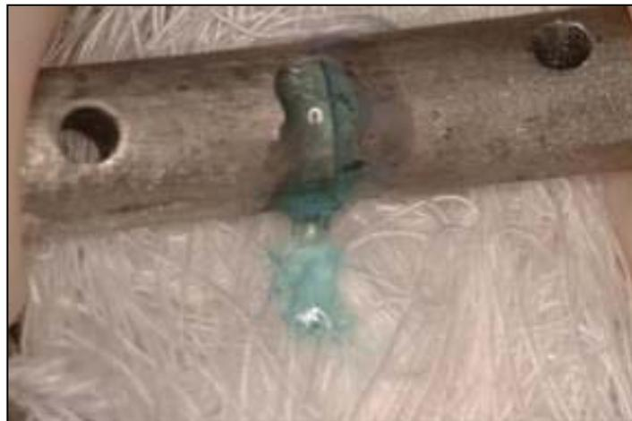
Figura 26 - Remoção do gel de proteção do cimento resinoso Bistite II DC, da superfície de cimentação do par de cilindros, com gaze.
