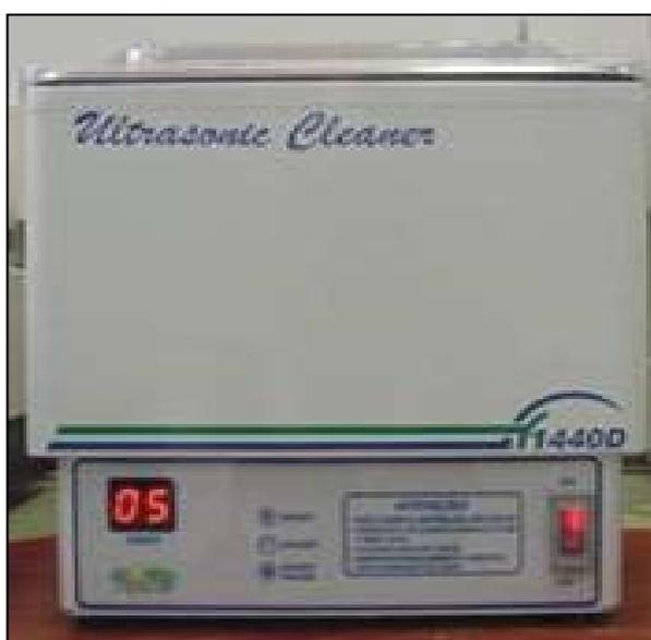
Figura 6 - Aparelho *Ultrasonic Cleaner* (modelo 1440 D, Odontobrás, Ind. Com. Equip. Med. Odontol. Ltda., Ribeirão Preto, SP, Brasil ) utilizado para a limpeza ultrasônica dos cilindros fundidos.
