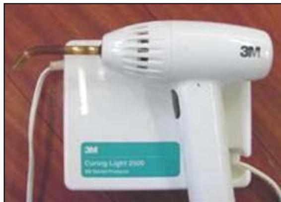
Figura 24 - Aparelho fotopolimerizador Curing Light 2500 (3M Dental Products, Saint Paul, EUA) utilizado para fotoativação dos cimentos resinosos de dupla ativação utilizados na pesquisa.
