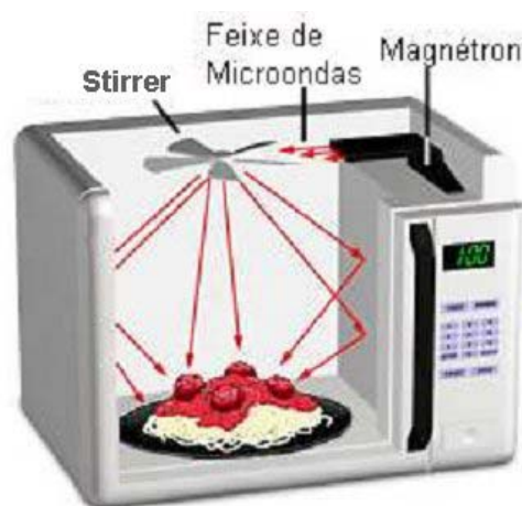
Figura 3.2 – Ilustração das propriedades elétricas dos materiais mediante o exemplo do forno de microondas [34].
