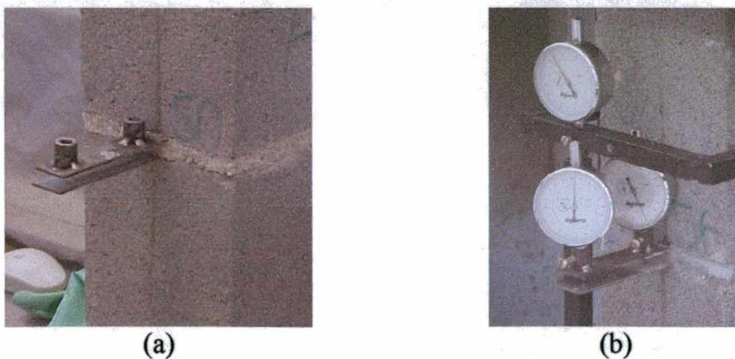
**FIGURA 4.21** – Equipamento de medida de deformação da junta utilizando dois relógios comparadores em prismas: (a) chapas pronta para ensaio e (b) chapas junto com os relógios para medida da deformação já instalados no prisma
