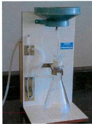
FIGURA 3.10 – Equipamento utilizado para a retenção de água
