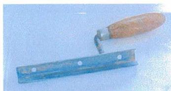
**FIGURA 4.6** – Colher canaleta utilizada para a simulação do assentamento
