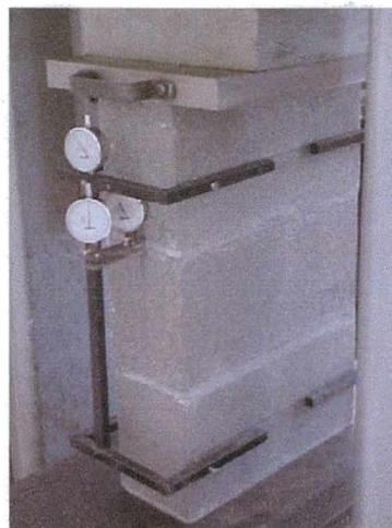
**FIGURA 4.18** – Equipamento de medição das deformações no prisma do conjunto bloco-argamassa e da deformação da junta de assentamento
