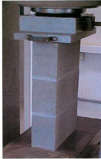
**FIGURA 4.15** – Ensaio de resistência à compressão em prisma
