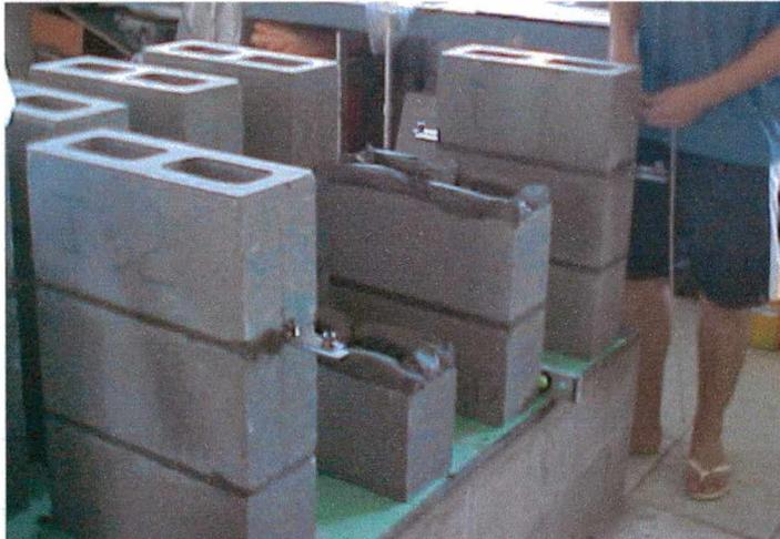
**FIGURA 4.14** – Moldagem dos prismas destinados a resistência à compressão e a deformação
